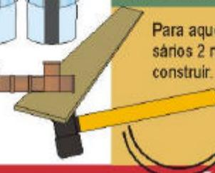
Um meio mais prático para promover esse encaixe é posicionar o módulo de cabeça para baixo e bater na vertical do módulo. Para tanto lembre-se de calçar a parte que ficará em contato direto com o chão para evitar quebra de tubos ou desmontar as colunas.
