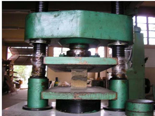
A NBR 8491.84 - especifica uma resistência mecânica ao ensaio de compressão axial de 2,0 MPa de média para cada amostra e uma resistência individual de 1,7 MPa. A tabela 02, abaixo mostra os resultados obtidos nos ensaios a compressão axial da mistura solo/ cinza pesada/ cimento, que obteve o melhor desempenho.
