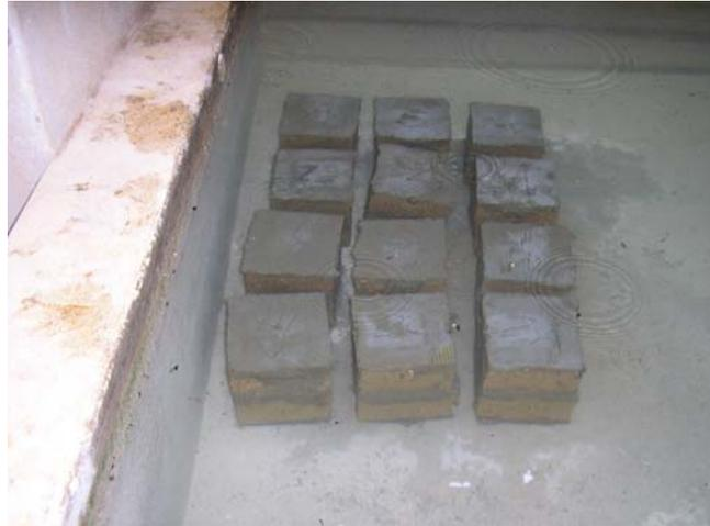
**Figura 04 - Corpo de prova saturado recebendo carga – ensaio de compressão axial**
